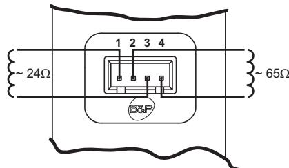
Рис.13 - Электрический разъем для подключения газового клапана
