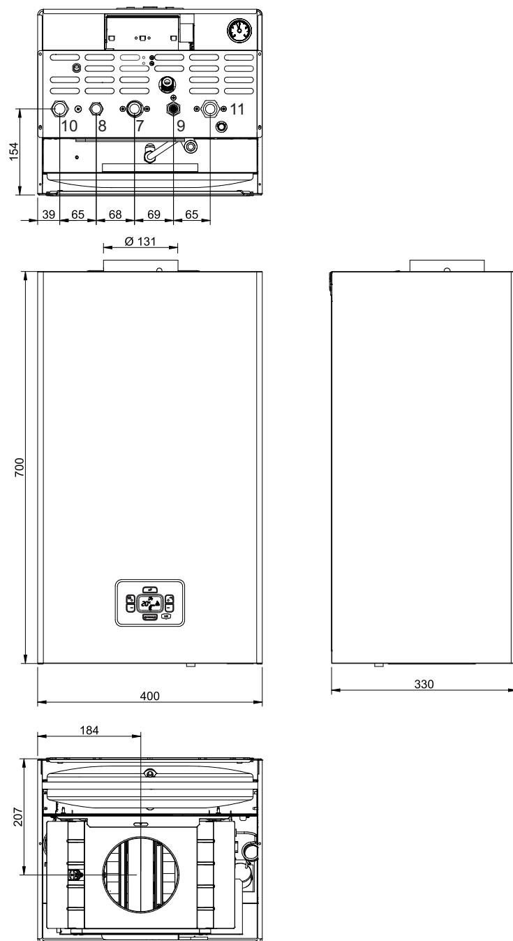
Рис. 15 - Размеры и соединения модели DIVA D C24
