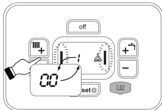
**Рис. 11 - Режим «TEST»**
