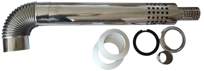
Рис 9А. Коаксиальный дымоход 80/127 (арт. 902601230)
