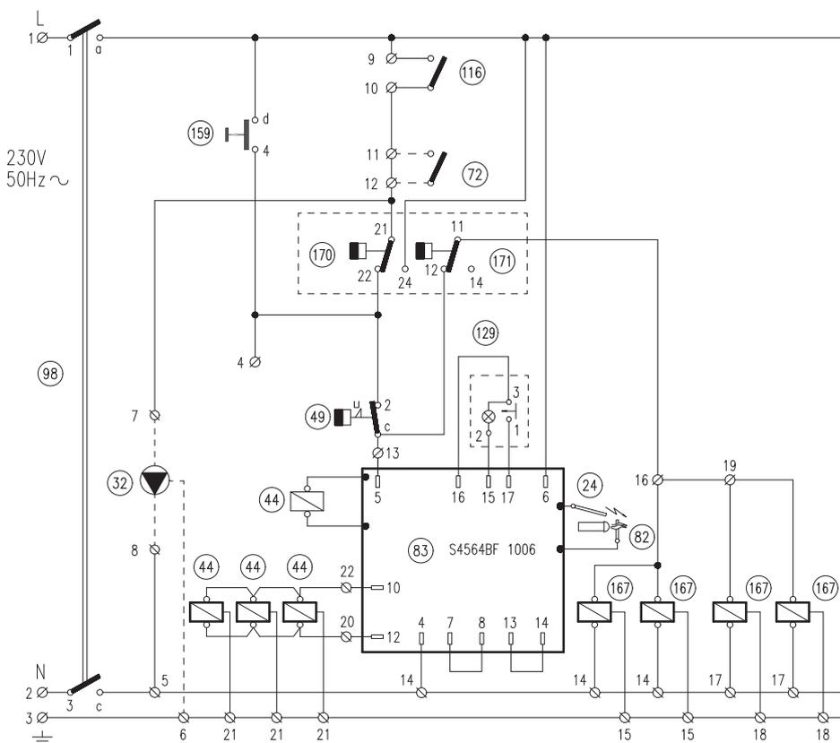
рис. 15 - Принципиальная электрическая схема мод. 153 ч 289
