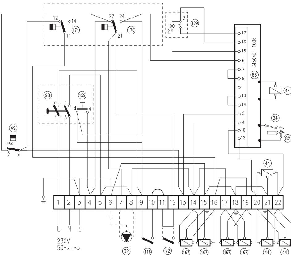
рис. 14 - Схема электрических соединений мод. 153 ч 289
